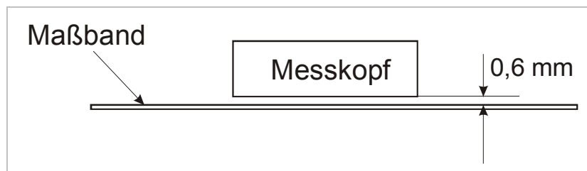
Abbildung 14: Abstand Maßband ↔ Messkopf
